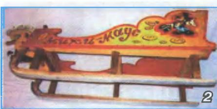
салазок при помощи опорных брусков с круглыми шилами на клею ПВА. Все детали стягивал шпагатом, чтобы клей схватывал прочнее. Верхний конец полозьев прикрепил к направляющей сиденья саморезами в заранее просверленные отверстия (фото 2). При сборке следил, чтобы не было перекосов. Изделие в зафиксированном положении выдерживал сутки.
